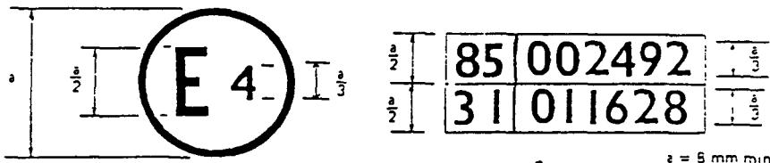
La marque d'homologation ci-dessus, apposée sur un véhicule, indique que le type de ce véhicule a été homologué aux Pays-Bas (E 4), en application des Règlements Nos 85 et 31(1)<sup>1</sup>. Les deux premiers chiffres du numéro d'homologation signifient qu'aux dates où les homologations respectives ont été délivrées, le Règlement No 85 n'avait pas encore été modifié, alors que le Règlement No 31 comprenait déjà la série 01 d'amendements.
