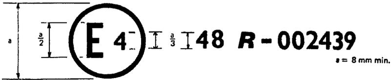
La marque d'homologation ci-dessus, apposée sur un véhicule, indique que le type de ce véhicule a été homologué aux Pays-Bas (E4), en ce qui concerne l'installation de dispositifs d'éclairage et de signalisation lumineuse, en application du Règlement n° 48. Le numéro d'homologation indique que l'homologation a été accordée conformément aux prescriptions du Règlement n° 48 dans sa forme originale.
