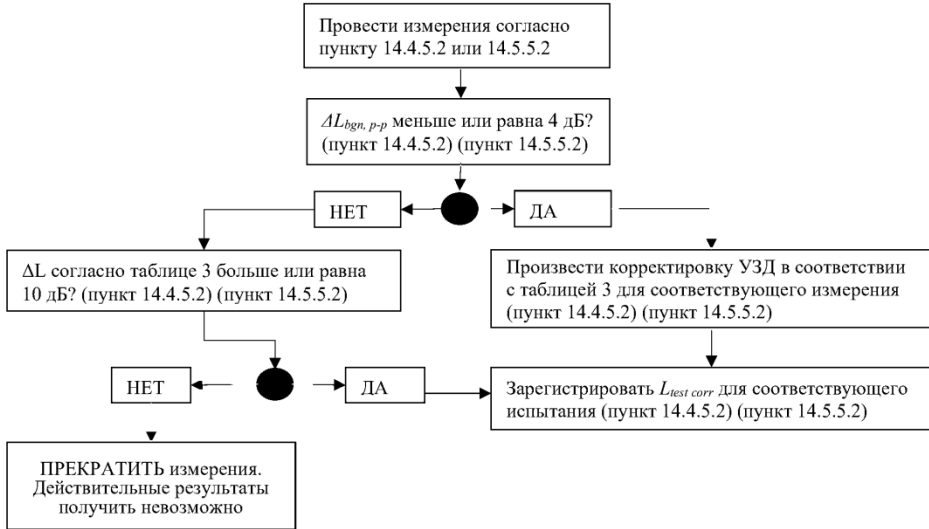
Рис. 2 Критерии корректировки измеренного значения взвешенного по шкале А уровня звукового давления транспортного средства
