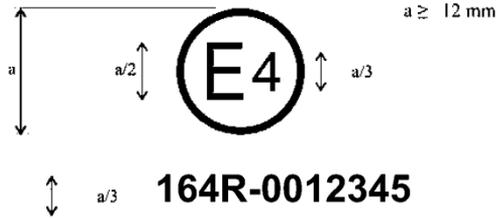
La marque d'homologation ci-dessus, apposée sur un pneumatique, indique que ce pneumatique a été homologué aux Pays-Bas (E 4) conformément au Règlement ONU n° [164] sous le numéro d'homologation 0012345. Les deux premiers chiffres de ce numéro (00) signifient que l'homologation a été accordée conformément à la série 00 d'amendements au présent Règlement.
