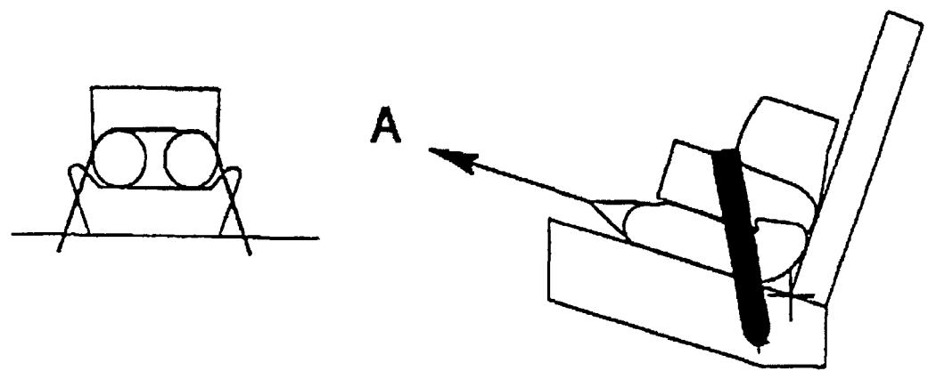
Figure 2: Essai de traction du coussin d'appoint en utilisant le bloc mannequin
